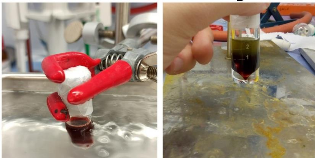
Zdjęcie 1. Synteza odczynnika Grignarda, pochodnej 3-trytyloksy-1-bromopropanu ( 10 ) (A). Sprzężanie Kumady, synteza 9,12-bis(3-O-trytyloksyprop-1-ylo)-1,2-dikarba- closo -dodekaboranu ( 11 ) (B).
